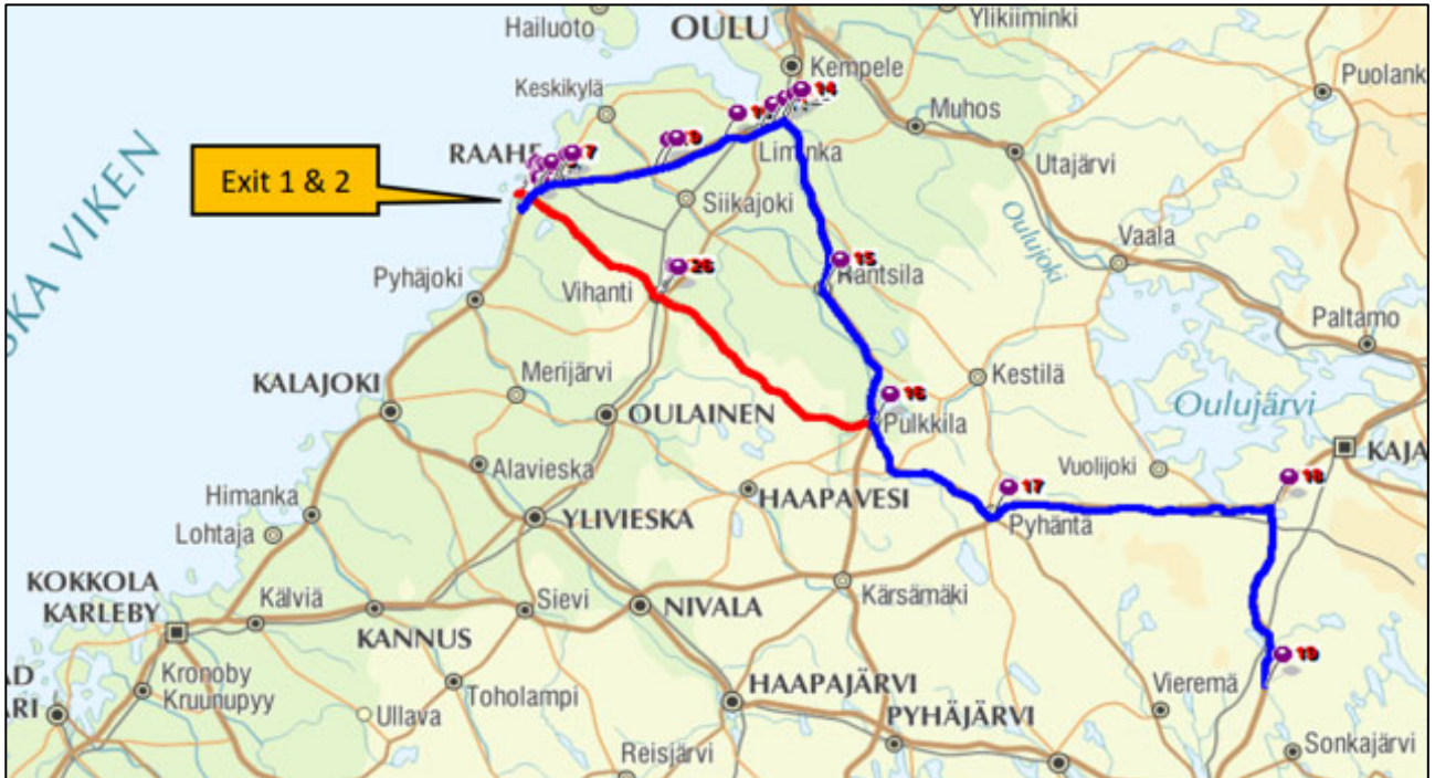
Kuva 36. Tuulivoimaloiden erikoiskuljetusreitti Raahen satamasta Sonkajärvelle. Sininen reitti=tuulivoimaloiden tornin erikoiskuljetus, punainen reitti=tuulivoimaloiden lapojen erikoiskuljetus (Silvasti, 2023).
