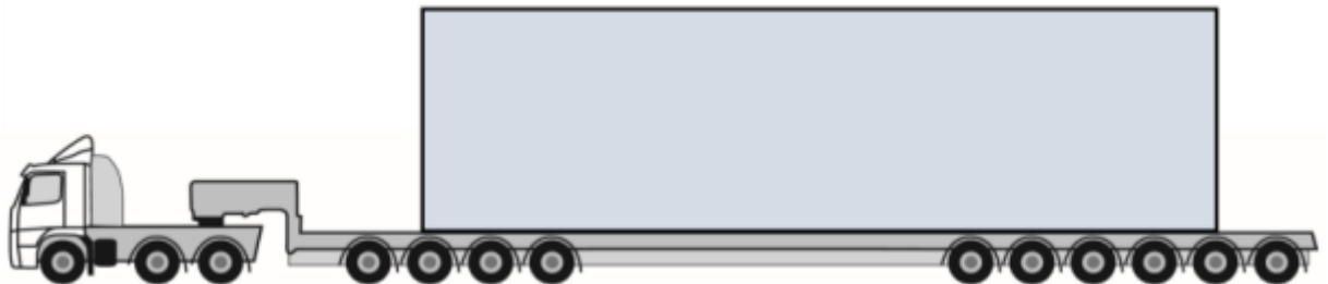
Kuva 2: Esimerkkikuva lastatusta tornilohkon erikoiskuljetuksesta (Tuulivoimarakentaminen tienpitäjän näkökulmasta)
