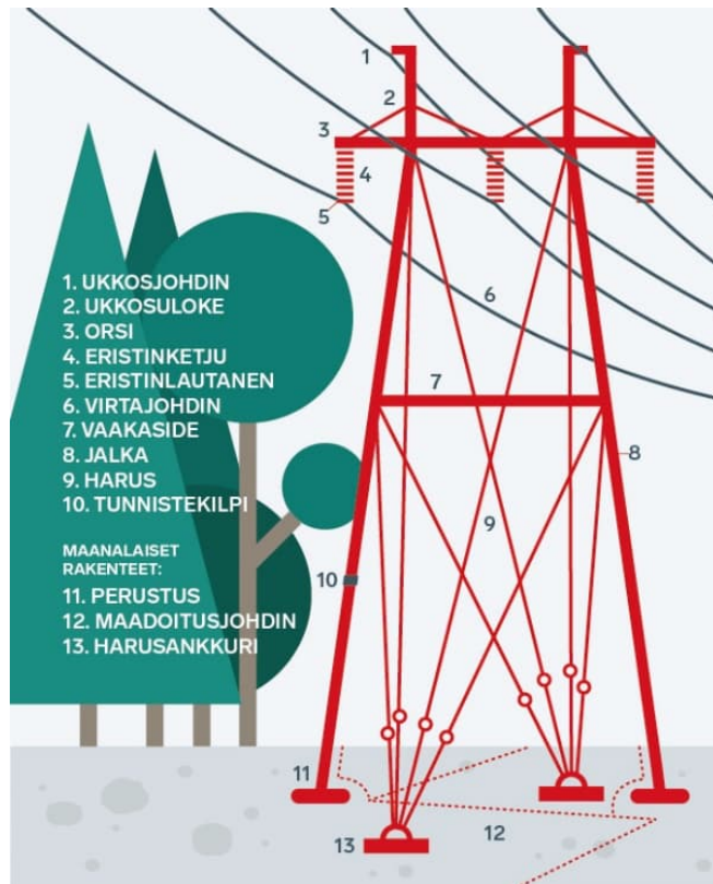
Kuva 3-3. Voimajohdon osat (Fingrid 2020).
